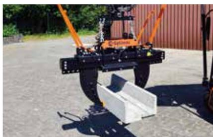
Der **Optimas Steingreifer Multiflex** eignet sich zum Setzen von Beton- und Granitbordsteinen, Rinnensteinen, Blockstufen und div. Platten. Durch Austausch der Greifbacken (optional) ergeben sich viele weitere Anwendungsmöglichkeiten, wie z. B. Setzen von Palisaden, L-Steinen, Natursteinen, Rasengittersteinen, Findlingen u. v. m.
