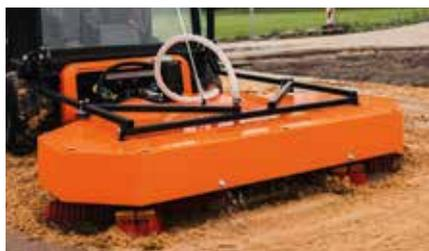
Das **Optimas Pflasterfugen-Füllgerät** für die Verlegemaschine ist optimal für das Einkehren von Fugenmaterial in Pflasterfugen auf mittleren und größeren Pflasterflächen geeignet. Durch die extreme Wendigkeit kann auch in Kurven und an Kanten das Fugenmaterial exakt in die Pflasterfugen eingekehrt werden.
