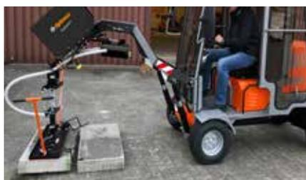
Mit dem **Optimas Vakuumgerät** können Beton- und Natursteinelemente alleine durch den Fahrer vom Paket aufgenommen und direkt an der gewünschten Position abgesetzt werden. Durch Montage unterschiedlicher Ansaugplatten kann das Vakuum-Anbaugerät zum Setzen von Beton- u. Natursteinplatten/-elementen genutzt werden.
