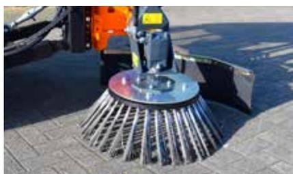
Mit der hydraulisch angetriebenen **Optimas Wildkrautbürste** entfernen Sie absolut mühelos und chemiefrei jegliche Art von Wildkräutern. Als Anbaugerät für die Optimas Pflasterverlegemaschine stellt die Wildkrautbürste ein optimales Reinigungssystem zur Beseitigung von hartnäckigem Schmutz auch in Randbereichen dar.
